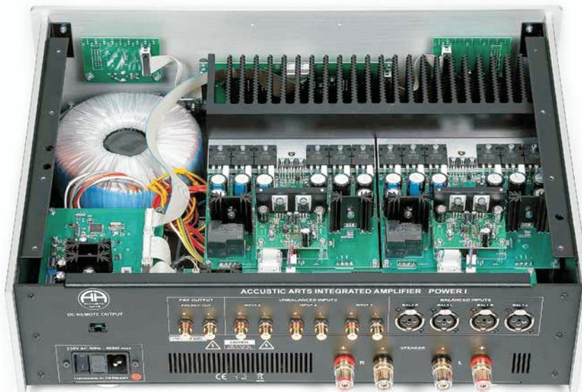
Je sechs Leistungstransistoren sitzen pro Kanal auf dem Kühlkörper. Der 500-Watt-Trafo wird von Kondensatoren mit 54.000 Mikrofarad gepuffert.
