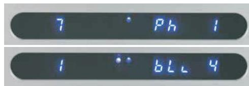
Zwei Beispiele aus dem Amp-Menü: Oben ist die Kopfhörerbuchse aktiviert; unten ist die Balance um den Wert „4“ nach links verschoben.
