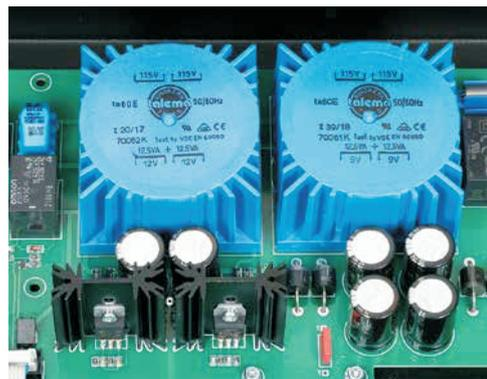
Zwei 25-Watt-Trafos versorgen die digitalen Kreise des PLAYER I samt Laufwerk und Steuerung sowie
